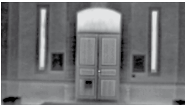
Test de déperdition énergétique réalisé à l'entrée de la mairie : plus la zone est claire plus la déperdition de chaleur est importante.
